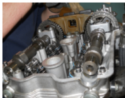
Der Blick auf die beiden Nockenwellen, die Steuerkette und den Ventilttrieb
