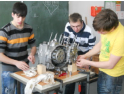
Der Zylinderkopf ist zerlegt, Anlasser und Lichtmaschine sind ausgebaut, der Kupplungskorb ist sichtbar
